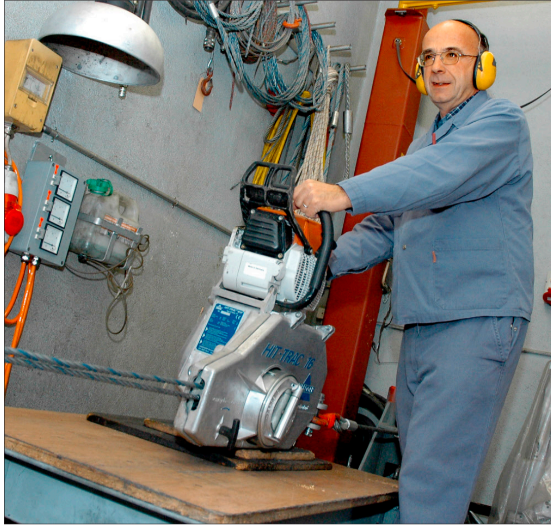
Mit dem 4,8-kW-Motorseilzug Hit-Trac 16B im Prüfstand: Peter Habegger, Geschäftsführer und Inhaber der Maschinenfabrik Habegger. (Bild: röt)
